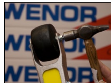
12. Slå et par lette slag på hver side av hjulbolten så spenninger i hjulet slipper, og hjulet ruller fritt.
