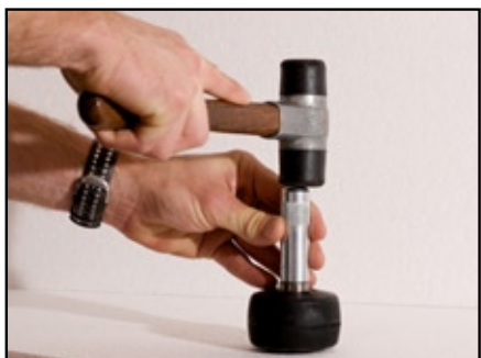
9. Slå inn et kulelager med hylsa. Sett tetningsbrikker på begge sider. Sett på mutter på begge sider.
